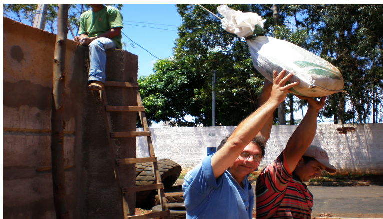
Figura 3 – Ensaio de impacto de corpo mole no lado externo da parede
