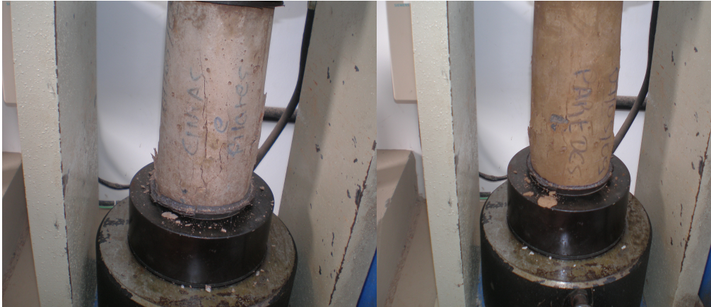
Figura 2 (a e b) – mostrando os ensaios à compressão dos corpos de prova do CEOD das cintas e pilares e das paredes.
