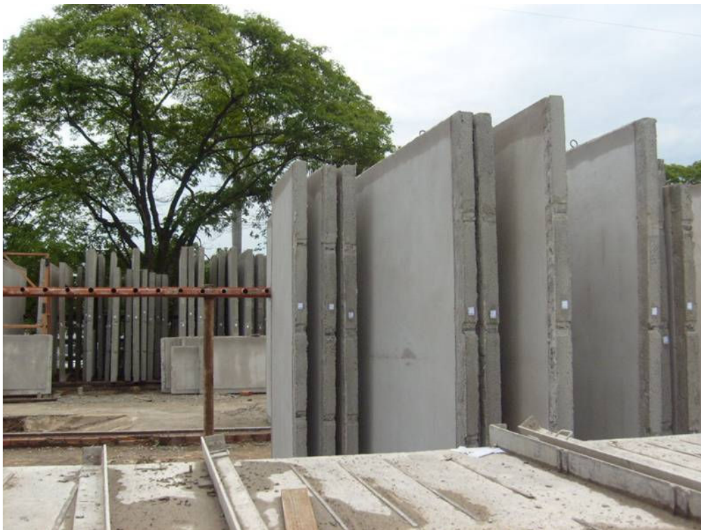
Figura 6: Painéis paredes prontos, estocados e identificados.
