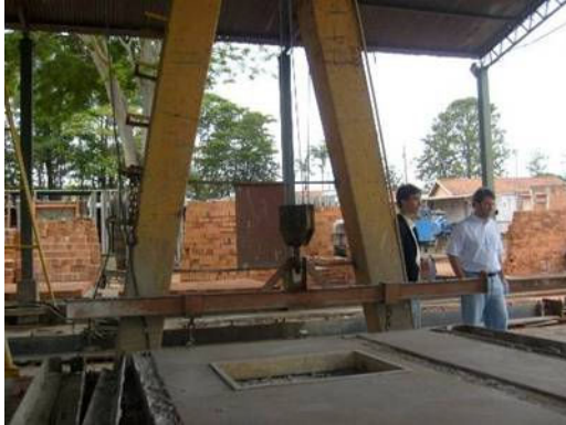
Figura 28: Painel pronto para ser içado.
