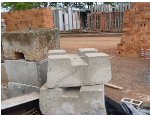
Figura 1: Bloco pré-moldado Jet Casa
